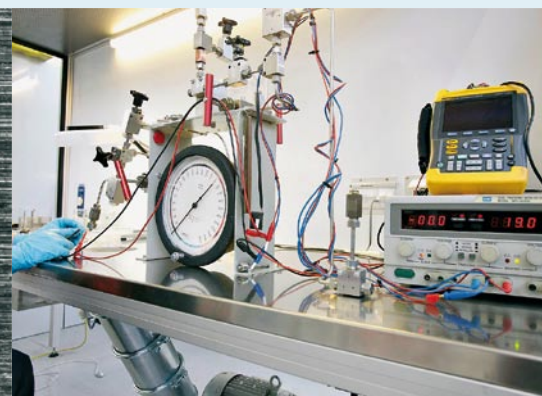
Flowbox : Le poste de travail à surpression garantit un montage précis dans un environnement exempt de poussières.
