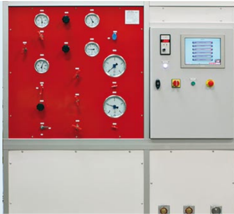
Installations d'essai commandées par automate.
