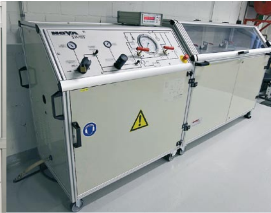
Banc d'essai pour le contrôle de l'étanchéité de composants Common Rail.
