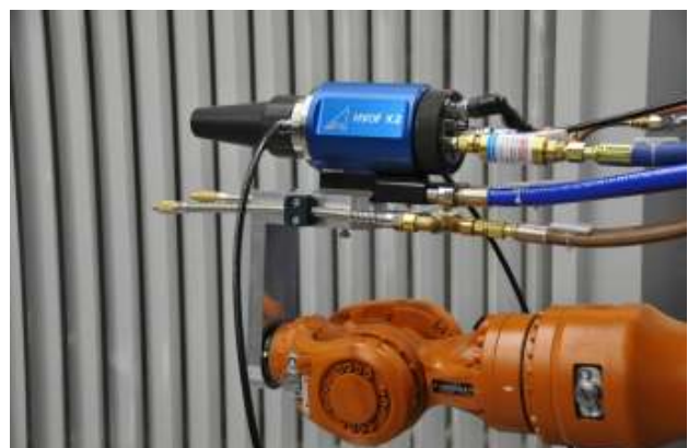
Spritzpistole mit integrierter zweifach Pulverzuführung
